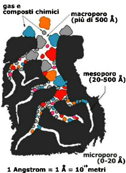
Immagine 10: granello di carbone attivo e suo adsorbimento schematizzato
