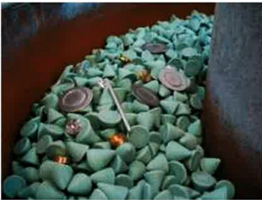
Immagine 2: burattatura con abrasivi sintetici
