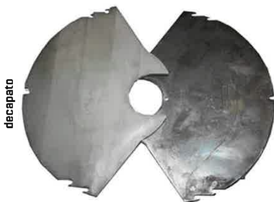
Immagine 10: particolare in alluminio prima e dopo il decapaggio/mordenzatura
