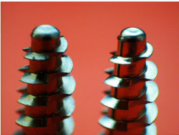
Immagine 7: particolare minuto in titanio prima e dopo il decapaggio
