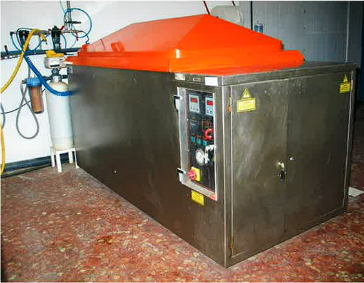
Immagine 9: camera per test di corrosione in nebbia salina
