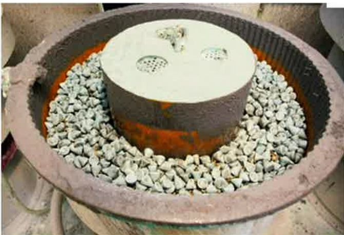
Immagine 3: vasca per vibrofinitura carica con abrasivi lapidei
