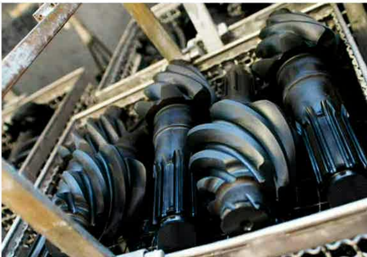
Immagine 10: particolari resi resistenti alla corrosione mediante fosfatazione allo zinco
