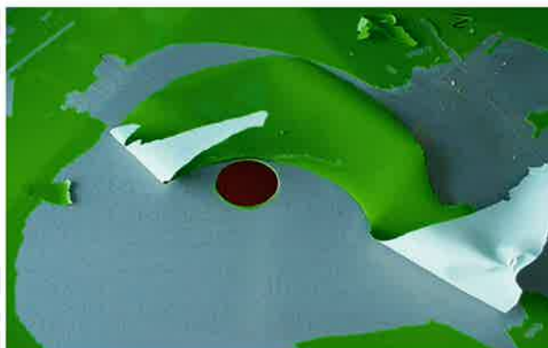
Immagine 16: vernice sfogliata da una superficie
