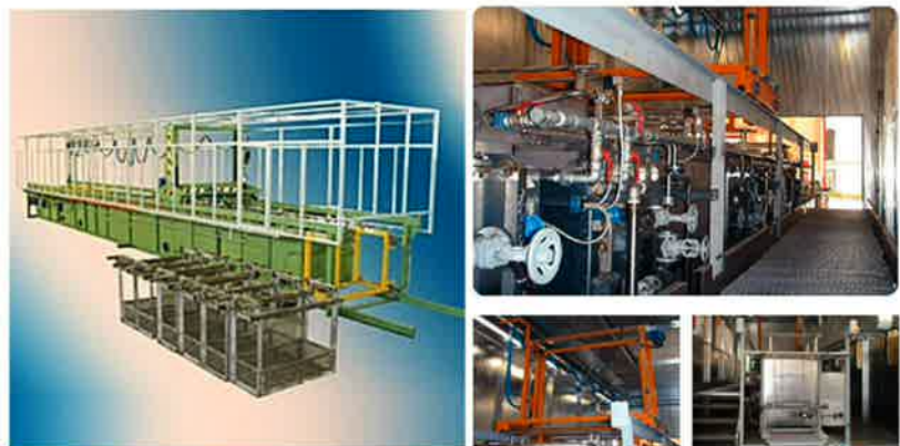
Immagine 14: esempi di impianti a immersione dotati di traslatore
