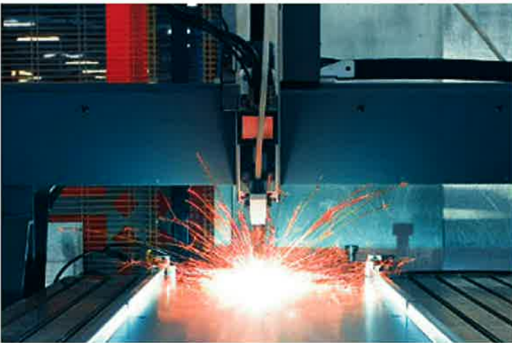
Immagine 27: saldatura ad arco elettrico a macchina
