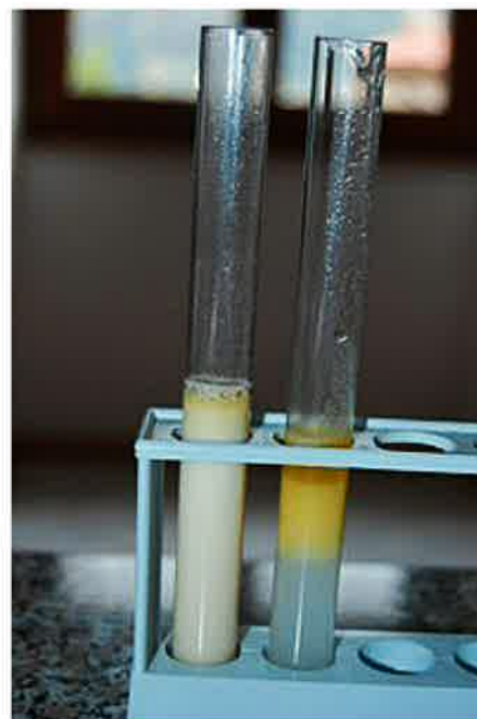
Immagine 3: emulsione olio-acqua prima e dopo la separazione
