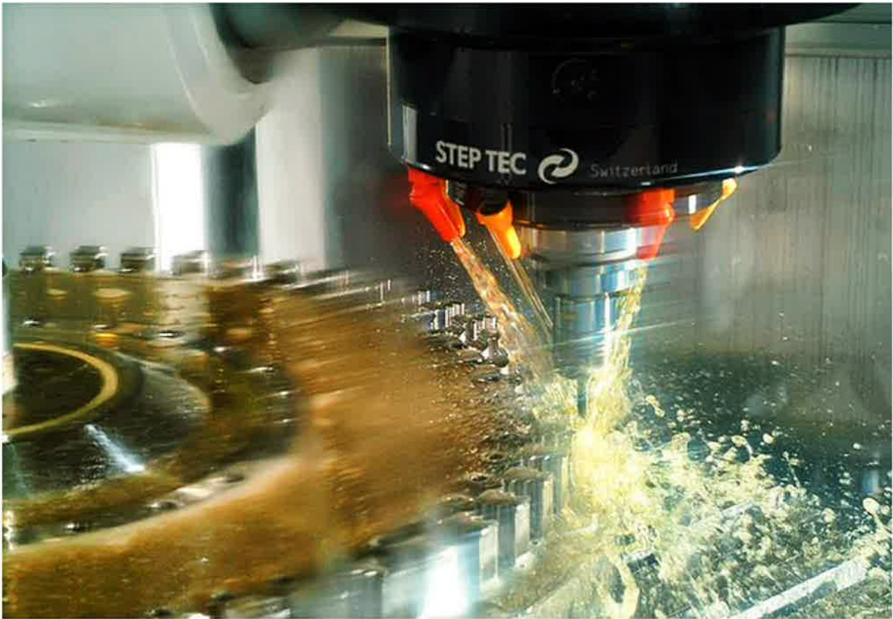
Immagine 3: lavorazione meccanica gravosa che si avvale come lubrorefrigerante di un olio emulsionabile
