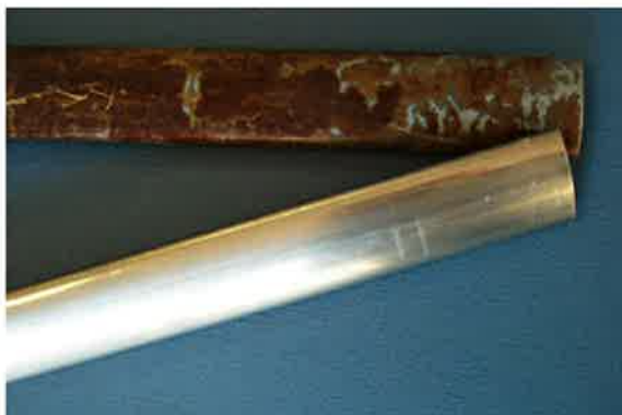
Immagine 5: particolare di ferro prima e dopo il decapaggio
