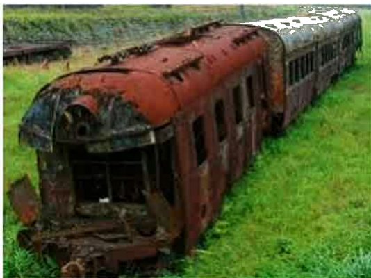
Immagine 2: effetti della corrosione chimica su un vecchio vagone ferroviario
