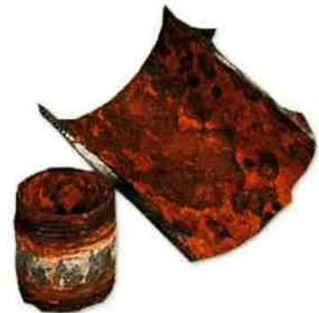
Immagine 6: componenti tubulari completamente corrose
