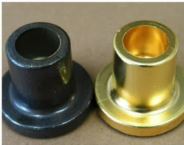
Immagine 9: particolare in lega di rame prima e dopo il decapaggio
